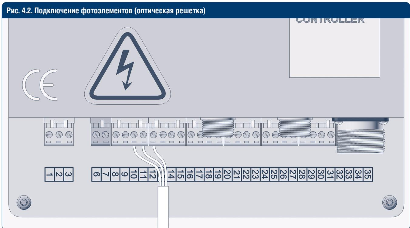
Рис. 4.2. Подключение фотоэлементов (оптическая решетка)
