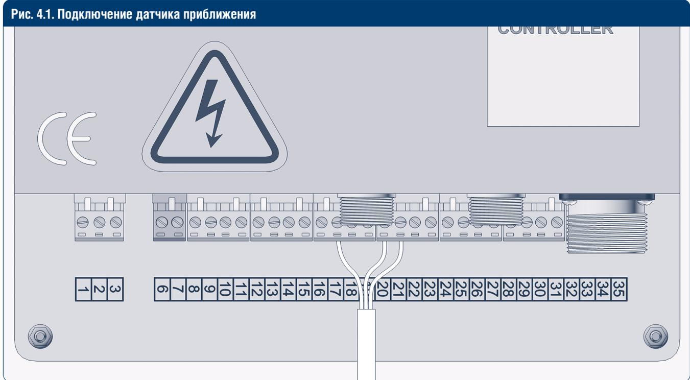
Рис. 4.1. Подключение датчика приближения
