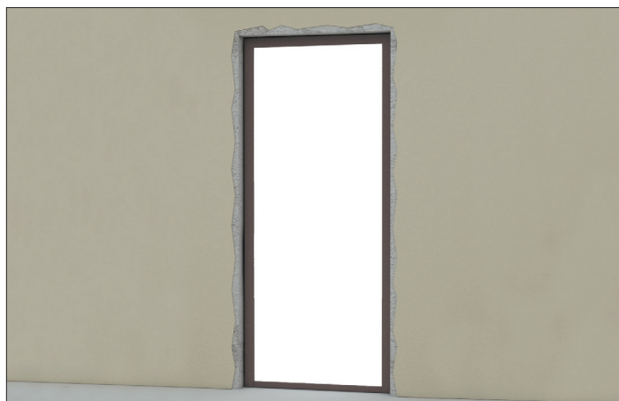
Установите дверную коробку (раму) в проем.
