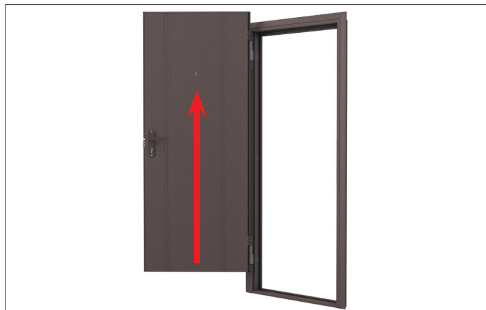
Снимите дверное полотно с петель.
