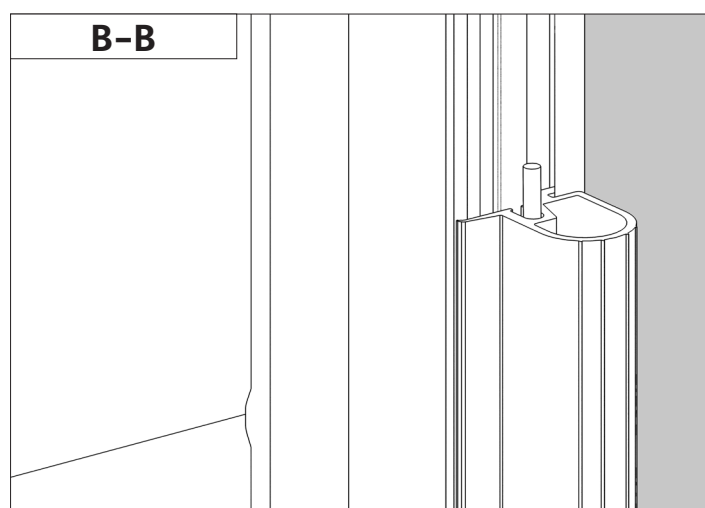
Схема прокладки кабеля обогрева в уплотнителе полотна.
