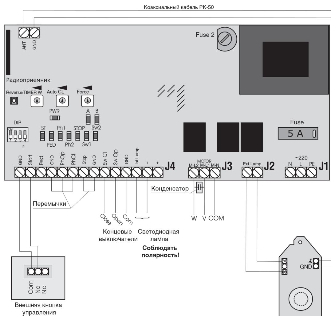
Подключение фотоэлементов на закрывание.
