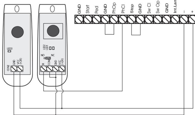
Подключение фотоэлементов на открывание.
