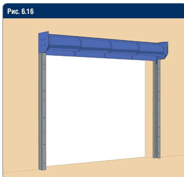
Просверлите отверстия в задней стенке короба под саморезы или анкерные болты.
