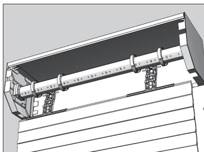
Сведите кольца до упора. Зафиксируйте положение колец саморезами. Вал сверлить запрещено! Саморез необходимо закручивать в радиальное отверстие ригельного кольца до упора в стенку вала. Не просверлите электропривод!
