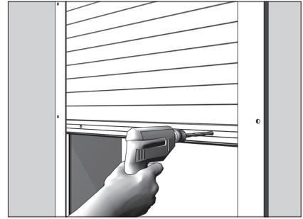
Просверлите отверстия для крепления стопоров в концевом профиле на расстоянии 50-100 мм от направляющих.
