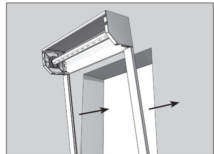
Установите каркас роллеты: приставьте каркас роллеты к проему при накладном монтаже; вставьте каркас в проем при встроенном монтаже.
