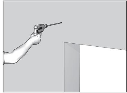
Рассверлите намеченные отверстия в стене для вывода элементов управления: для вывода кабеля электродвигателя, шнура – отверстие  $\varnothing 12$  мм; для вывода ленты – отверстие  $\varnothing 16-18$  мм; для вывода кардана, корда – отверстие  $\varnothing 14-16$  мм; рассверлите отверстие  $\varnothing 20$  мм на необходимую глубину под цилиндрический выступ кардана.
