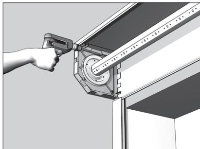
Наметьте и просверлите отверстие в задней крышке короба и стене над шкивом для вывода ленты, шнура или корда.
