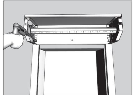
Просверлите отверстия в крышке короба и стене для крепления короба.
