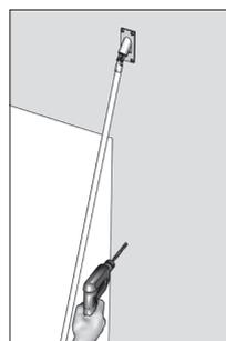
Наметьте и просверлите отверстия для крепления клипсы (при ее наличии в комплектации). Закрепите клипсу саморезами.
