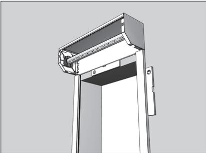
Каркас роллеты должен быть установлен строго вертикально (проверьте строительным уровнем).
