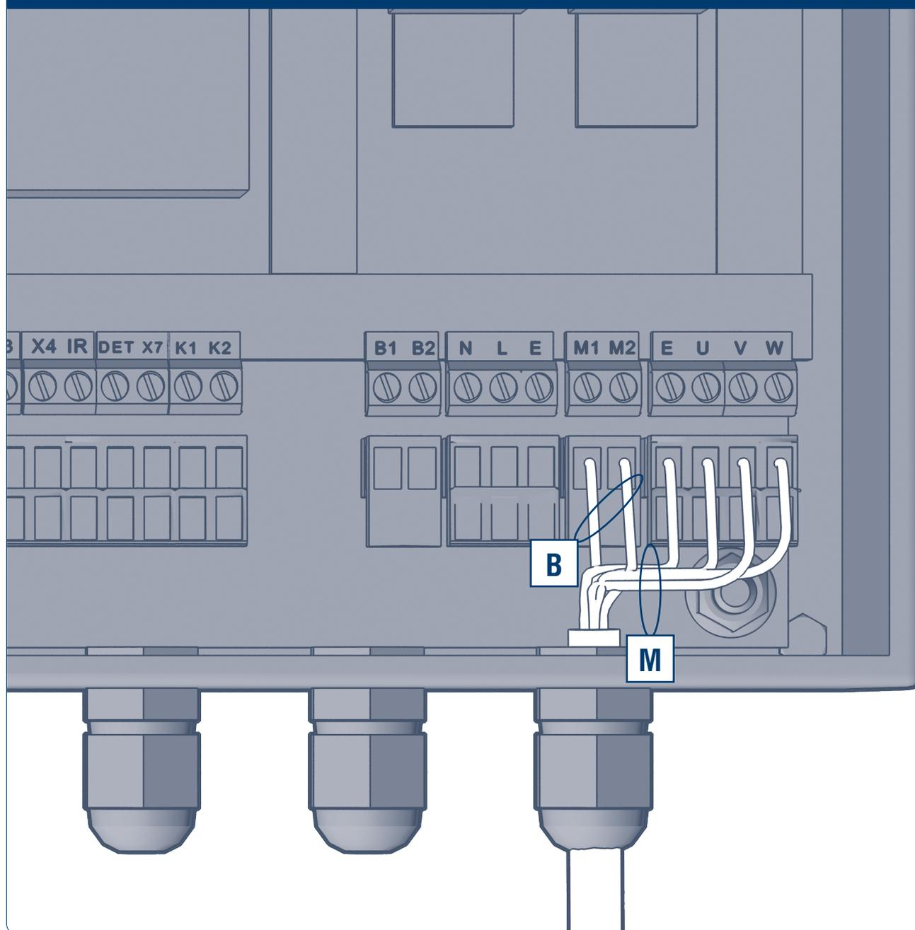
В — электромагнитный тормоз двигателя
