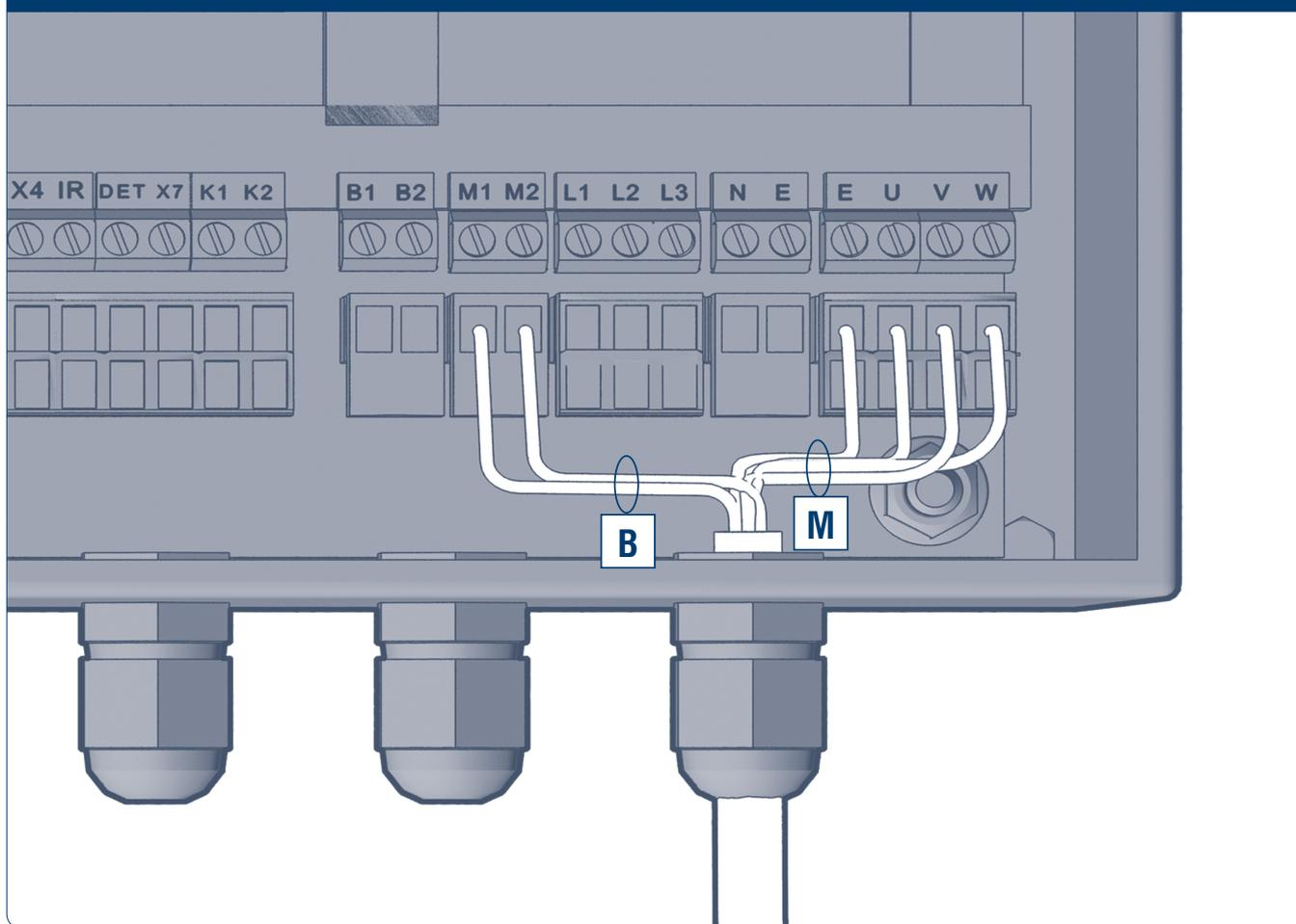
В — электромагнитный тормоз двигателя
