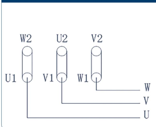
Рис. 5. Схема «звезда»
