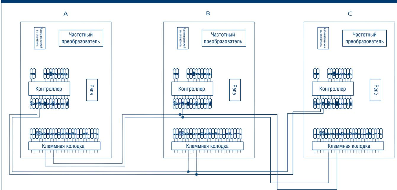
A and B interlock (Блокировка А и В)
