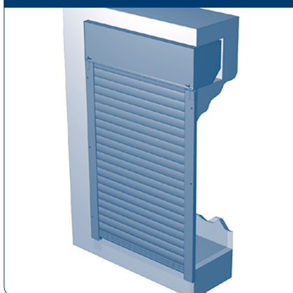
Рис. 6.2.2. Накладной монтаж, короб внутрь
