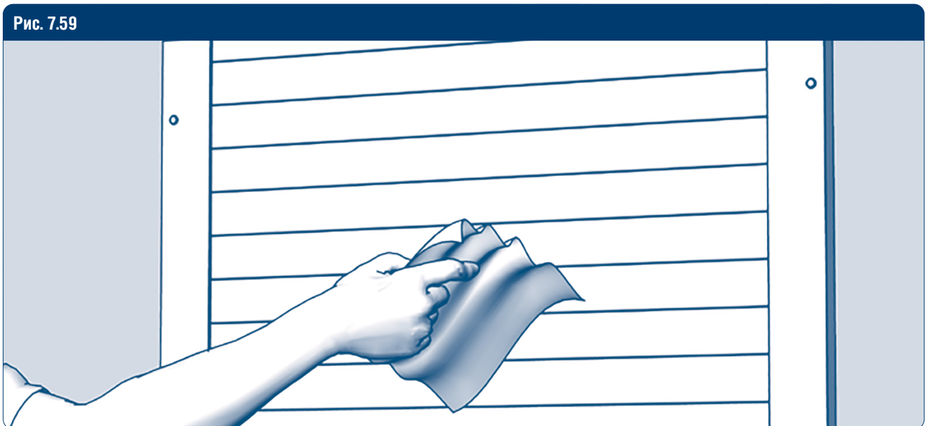
После завершения работ по монтажу роллет и отделке фасада здания удалите защитную пленку с конструкции роллеты. Очистите загрязненные участки.
